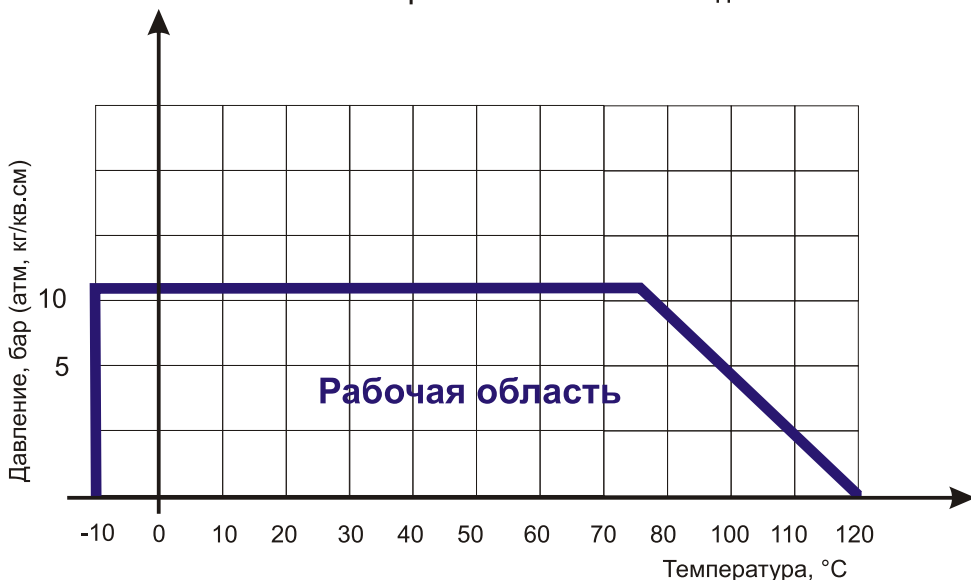
Диаграмма Давление / Температура для задвижки клиновой ABRA-A40-10G с обрезиненным клином и неподвижным штоком DN 200-600 PN 10:
